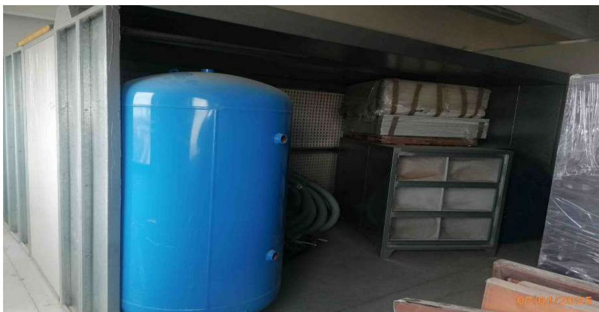
Pressurizzatore cabina verniciatura per stanza esistente composto da plenum con microfiltri “ Cod. inventario M14”
