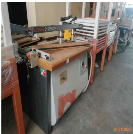
Foratrice mono testa Maggi modello Boring System 29 “Cod. inventario M13”
