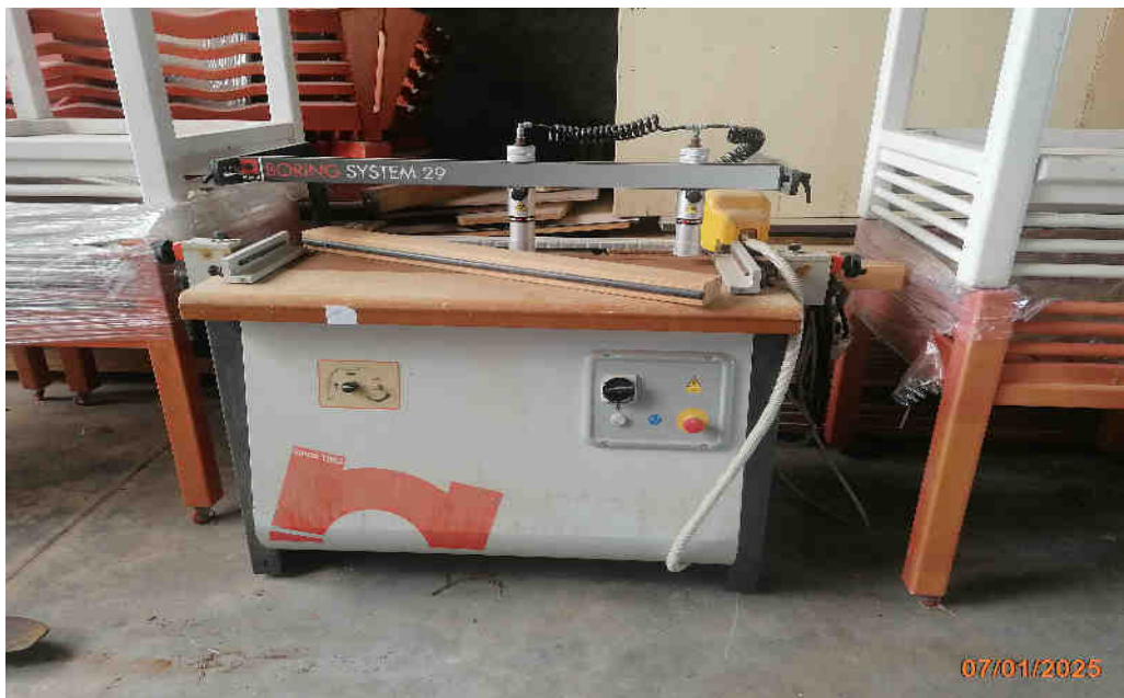
Foratrice mono testa Maggi modello Boring System 29 “Cod. inventario M13”
