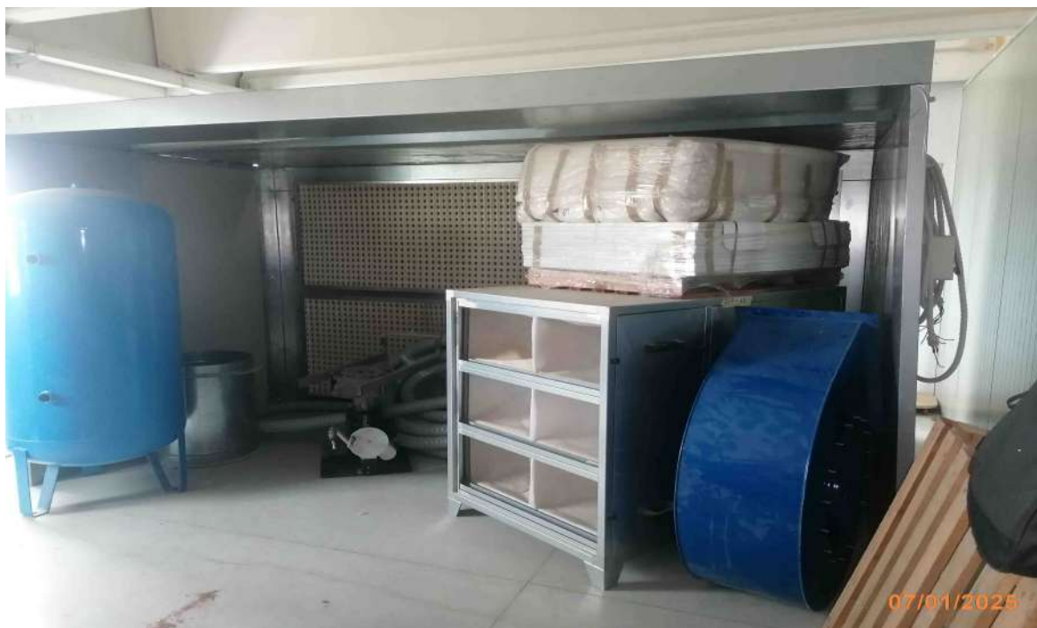
Pressurizzatore cabina verniciatura per stanza esistente composto da plenum con microfiltri “ Cod. inventario M14”
